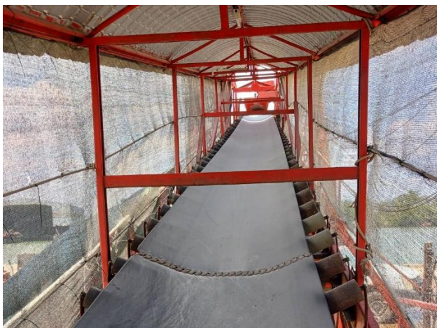
การปิดคลุมสายพานลำเลียงด้านข้างด้วยผ้าสแลน
