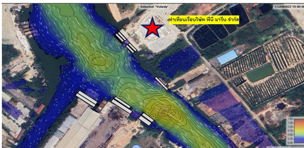
(ค) สภาพการไหลกรณีมีเรือขนาดเล็กจอด 2 แถว และมีท่าเทียบเรือข้างเคียงและฝั่งตรงข้ามร่วมด้วย
